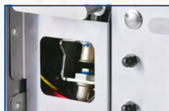
Generator iskry zasilany na 230 V
